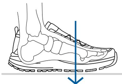
La barre de déroulement décalée vers l'arrière facilite le processus d'enroulement et réduit la pression au niveau de l'avant pied.
